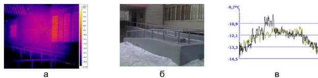
а – термографиялық сурет; б – нақты көрініс; в – сызық бойынша температура графигі Сурет 5 – № 14 термографиялық сурет
