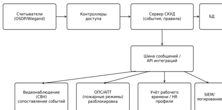
Рисунок 1 – Структурная схема СКУД и интеграций (пример)
