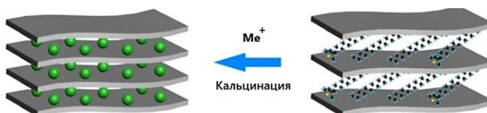
Сурет 1 – МХеңе қабаттарын интеркаляциялау процессі
