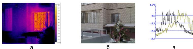
а – термографиялық сурет; б – нақты көрініс; в – сызық бойынша температура графигі Сурет 6 – № 15 термографиялық сурет
