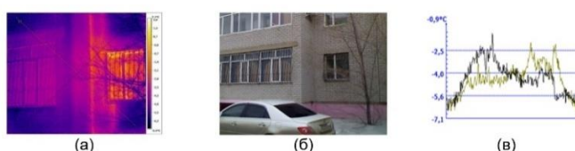
а – термографиялық сурет; б – нақты көрініс; в – сызық бойынша температура графигі
