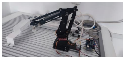
Рисунок 2 – Манипулятор-сортировщик с вакуумным ИМ
