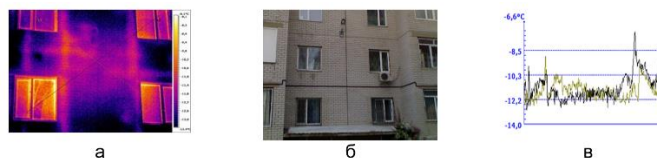
а – термографиялық сурет; б – нақты көрініс; в – сызық бойынша температура графигі Сурет 7 – № 16 термографиялық сурет
