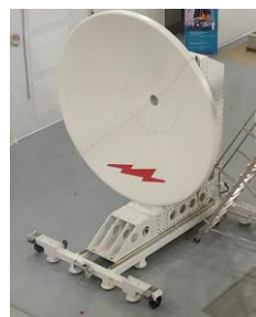
б) собранное зеркало на поворотной опоре
