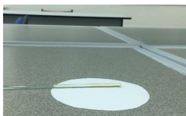
Рисунок 4 – Апробированная тест-система в молоке с карбофосом (>0,05 мг/кг) на основе альгината натрия (2%)
