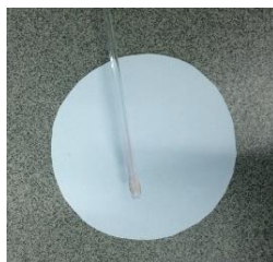
Рисунок 3 – Апробированная тест-система в молоке с карбофосом (>0,05 мг/кг) на основе пектина (2%)
