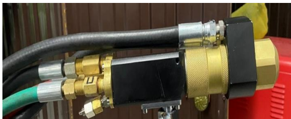
Рисунок 1 – SX-5000 для получения покрытия методом HVOF
