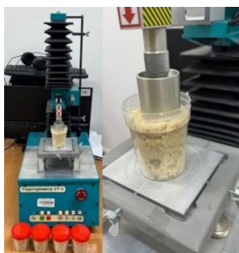
Рисунок 2 – Структурометр СТ-2 с индентором «Цилиндр»
