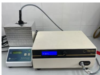
Рисунок 1 – Установка для определения теплопроводности наножидкости
