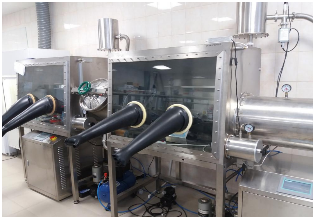
Сурет 6 – Жоғары таза инертті газды атмосфераға толы ГБ02М қос қолғаптық бокс жүйесі
