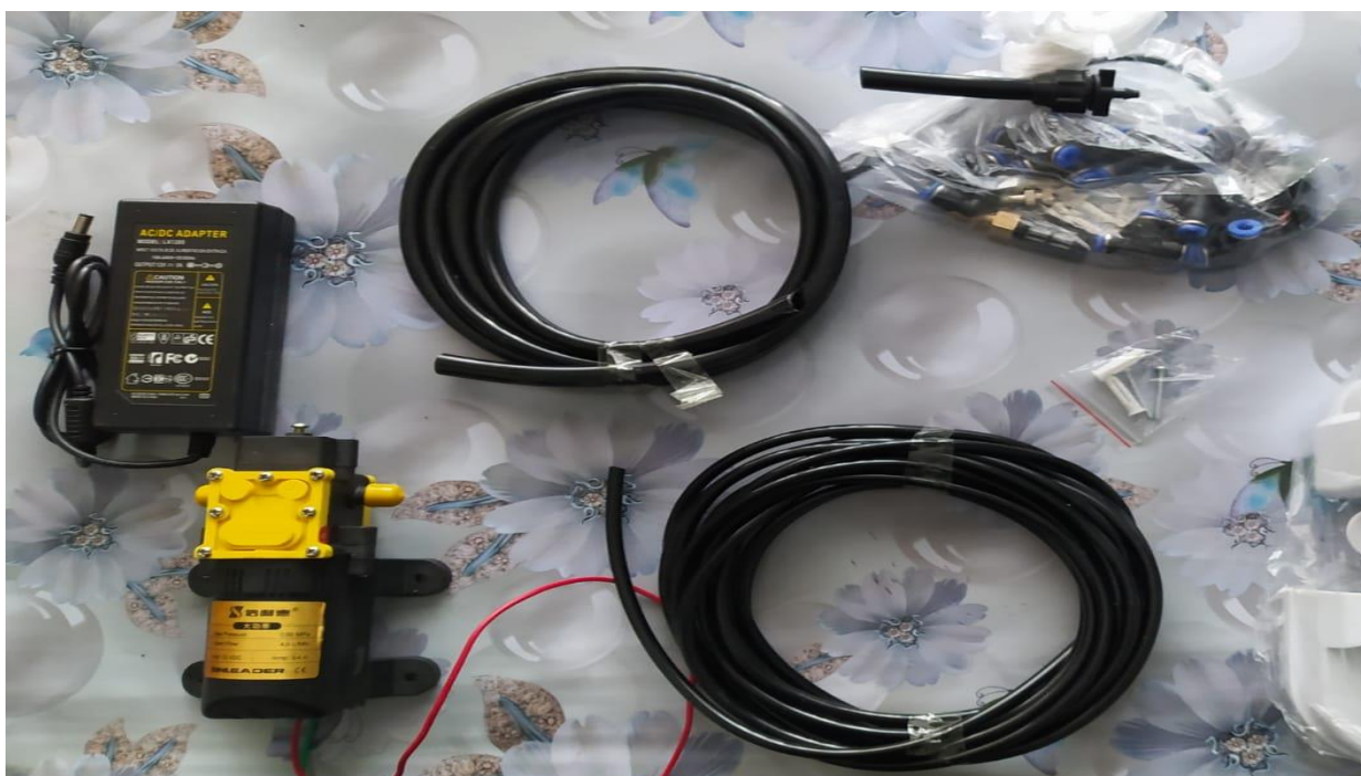
Рисунок В.4 – Детали для сборки «Установки для обработки сельскохозяйственных животных» (гибкие трубопроводы, форсунки, насос и другое)
