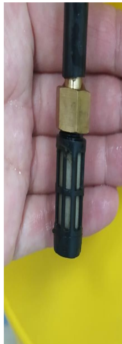
Рисунок В.6 – специальный фильтр для защиты насоса
