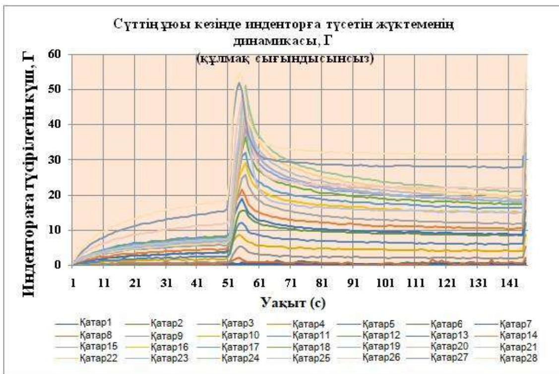
Сурет 6 – Сүттің ұю процесін зондтау кезінде инденторға түсетін жүктеменің өзгеру динамикасы (құлмақ сығындысынсыз)
