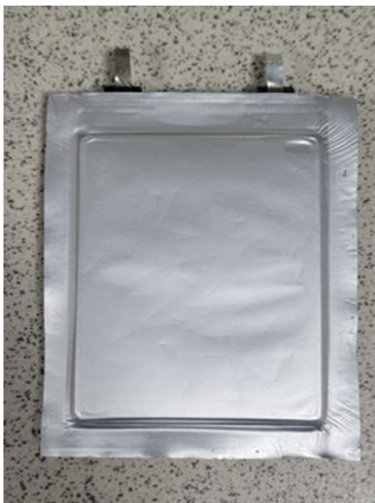
Сурет 10 – V_2O_5/CF_x негізіндегі призмалық литий тоқ көзінің прототипі
