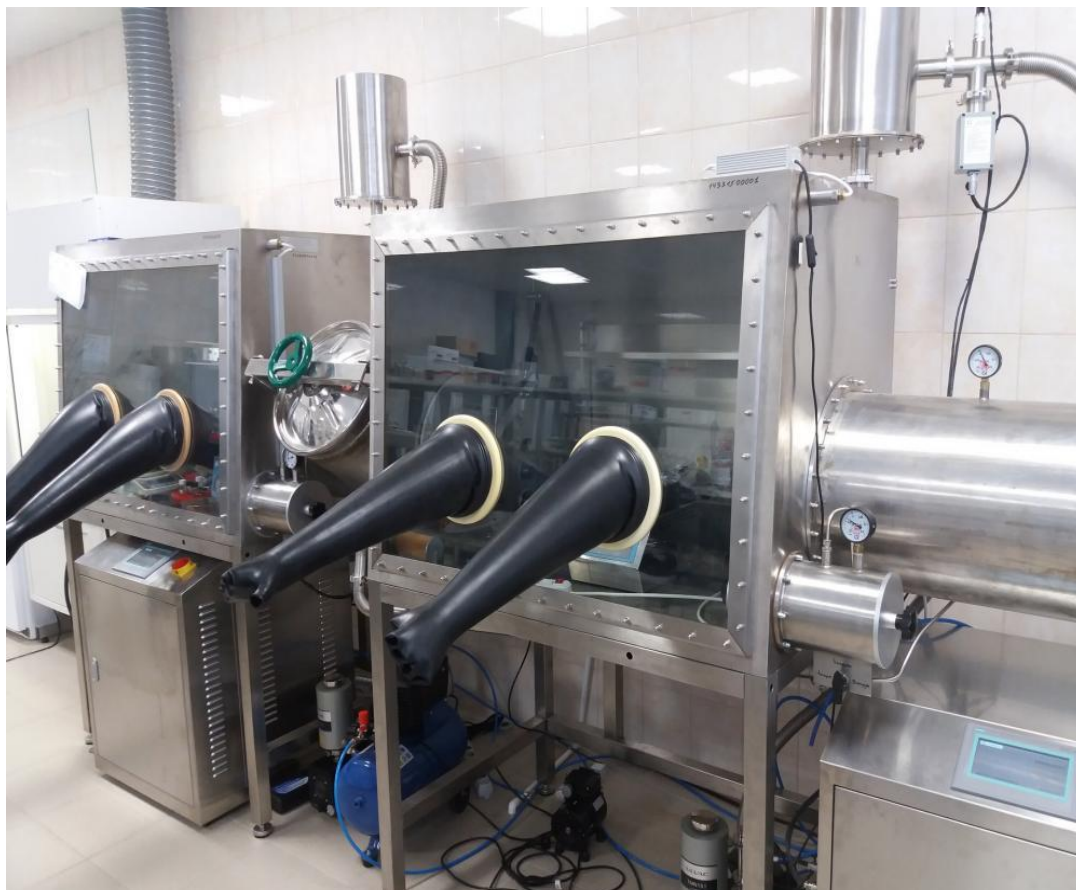
Сурет 6 – Жоғары таза инертті газды атмосфераға толы GB02M қос қолғаптық бокс жүйесі
