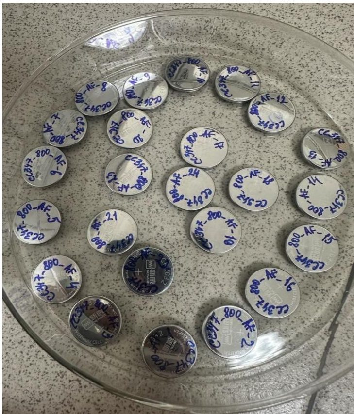
Сурет 5 – Дайын 2032 форматындағы дискілік қуат элементтерінің үлгілері
