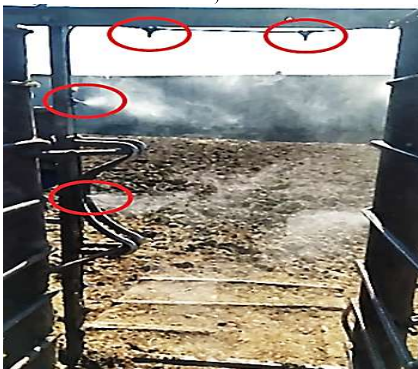
Рисунок 18 – Действие УОСЖ: А - «Установка для обработки сельскохозяйственных животных», Б - регулируемое расположение форсунок
