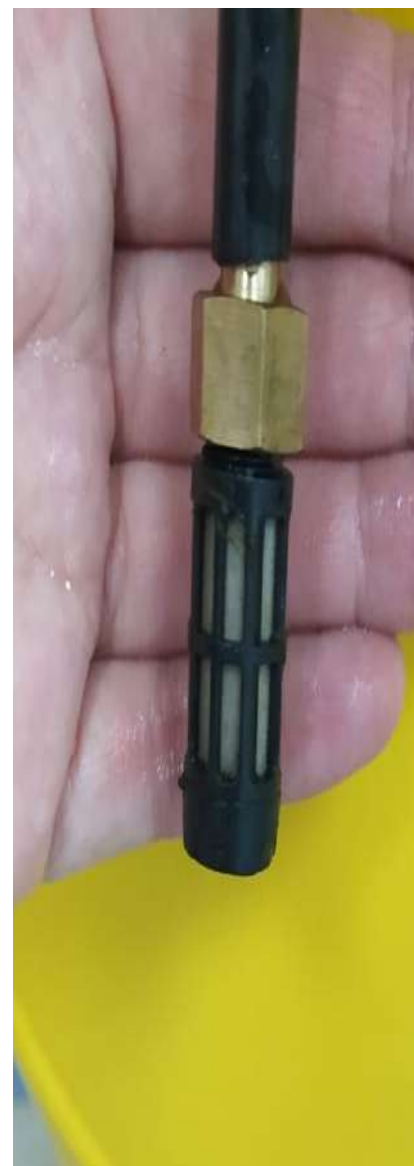
Рисунок В.6 – специальный фильтр для защиты насоса
