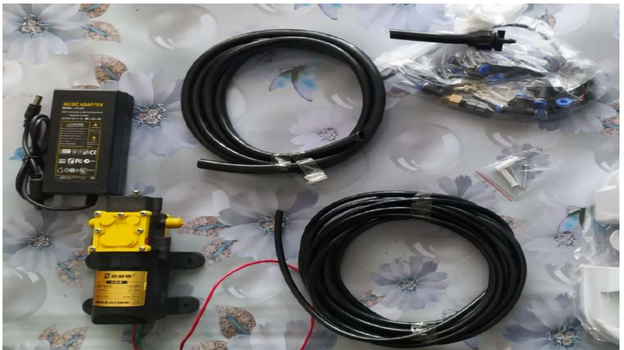
Рисунок В.4 – Детали для сборки «Установки для обработки сельскохозяйственных животных» (гибкие трубопроводы, форсунки, насос и другое)
