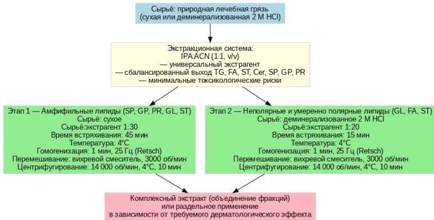
Рисунок Ж.1 – Схема, иллюстрирующая разработанный метод двухэтапной экстракции липидов из природной грязи
