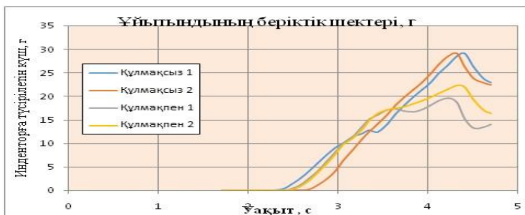
Сурет 10 – Ұйытындының беріктік шектерін зерттеу (индентордағы күш)
